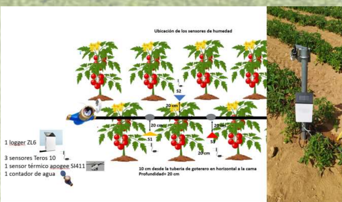
Figura 2: Esquema de la instalación de sensores en campo
